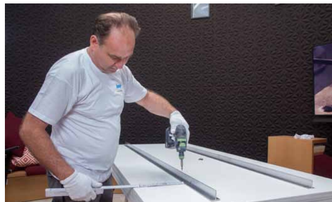
Obr. 18: Namontujte vyztužení na zadní stranu
