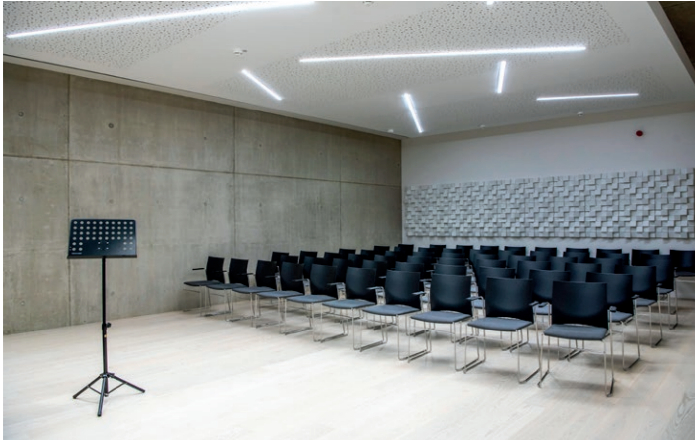
> V malém koncertním sále najdete kombinaci sádrokartonových podhledů a akustických předstěn s deskami Cleaneo. Některé části jsou z betonového monolitu.
