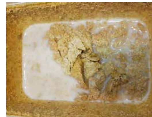
> Přemrzlá penetrace Aufbrennsperre – zcela se oddělí pojivová část
