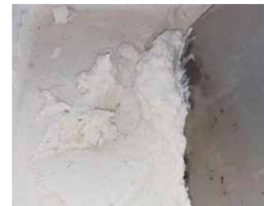
> Přemrzlý Goldband Finish – výrobek není hladký, ale zhrudkovatělý a nerozmíchatelný. Na povrchu je oddělená vrstva vody, která nelze, nebo lze zcela obtížně, vmíchat zpět
