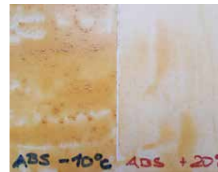
> Penetrace Knauf Aufbrennsperre aplikovaná po přemrznutí (ABS -10 °C) a při standardních skladovacích a aplikačních podmínkách (ABS +20 °C)
